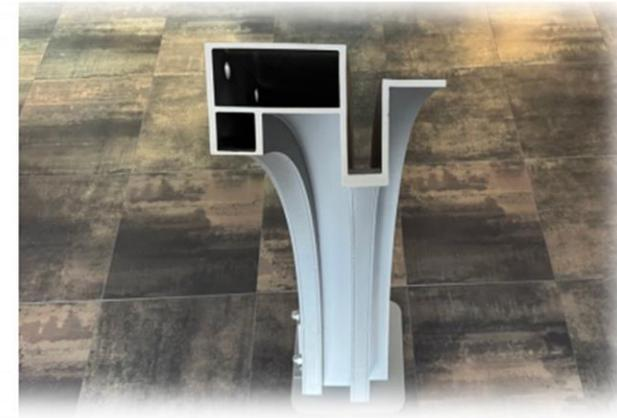
E-Profil mit  $h = 450 \text{ mm}$ ,  $b = 90 \text{ mm}$   $s = 10 \text{ mm}$  (Steg) und  $15 \text{ mm}$  (Flansch)
